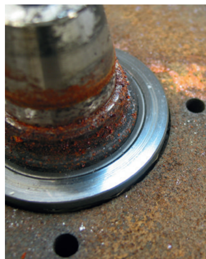
Vedação de anel deslizante destruída – a superfície de deslizamento foi corroída por partículas estranhas
