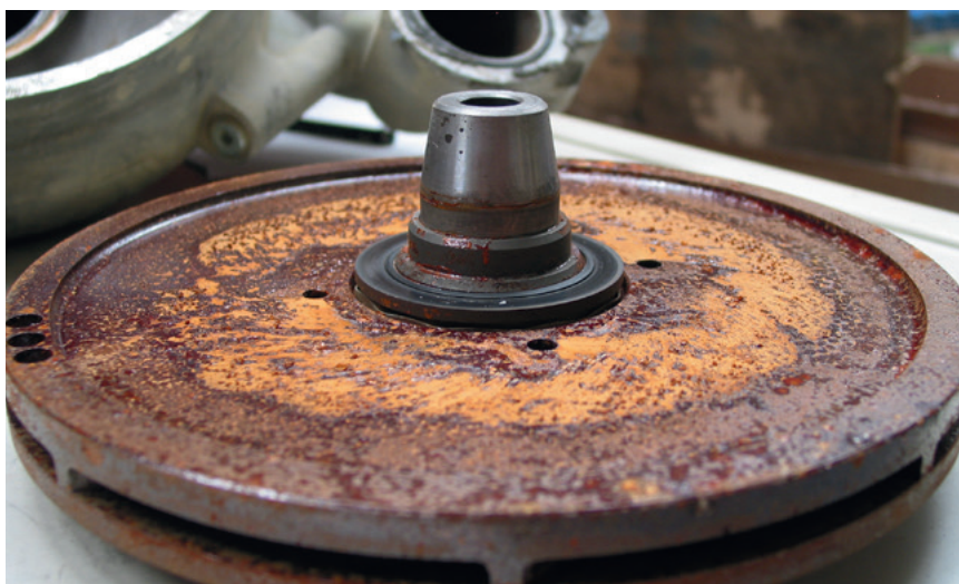
Roda de pás corroída
